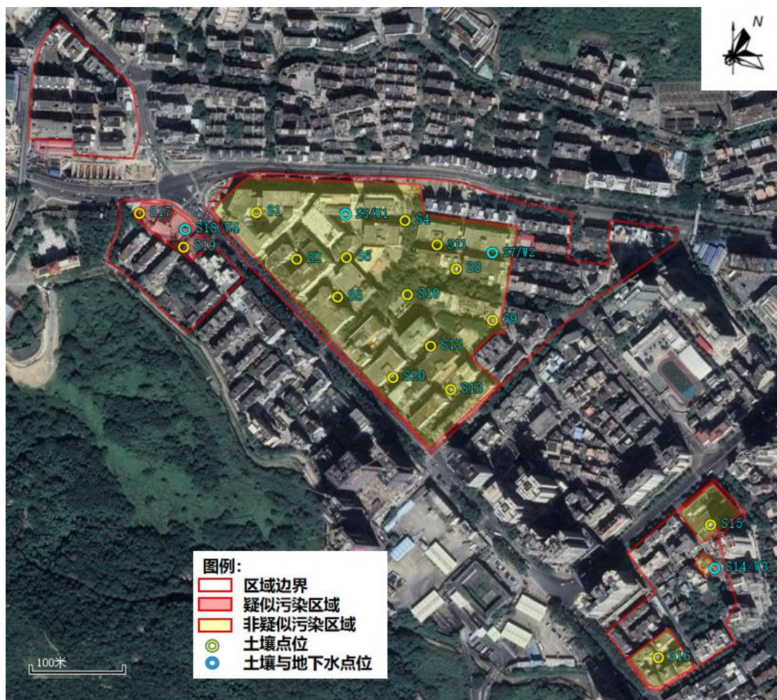
图 4.2-1 场地土壤和地下水监测点布设图
